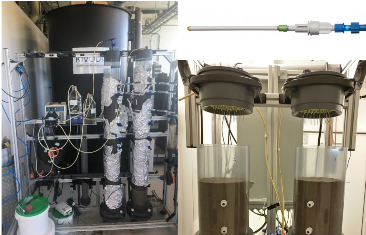
Figuur 6.2: Overzichtsfoto van de kolomopstelling en detail van de regenkap (rechtsonder) en MacroRhizon samplers (rechtsboven).
