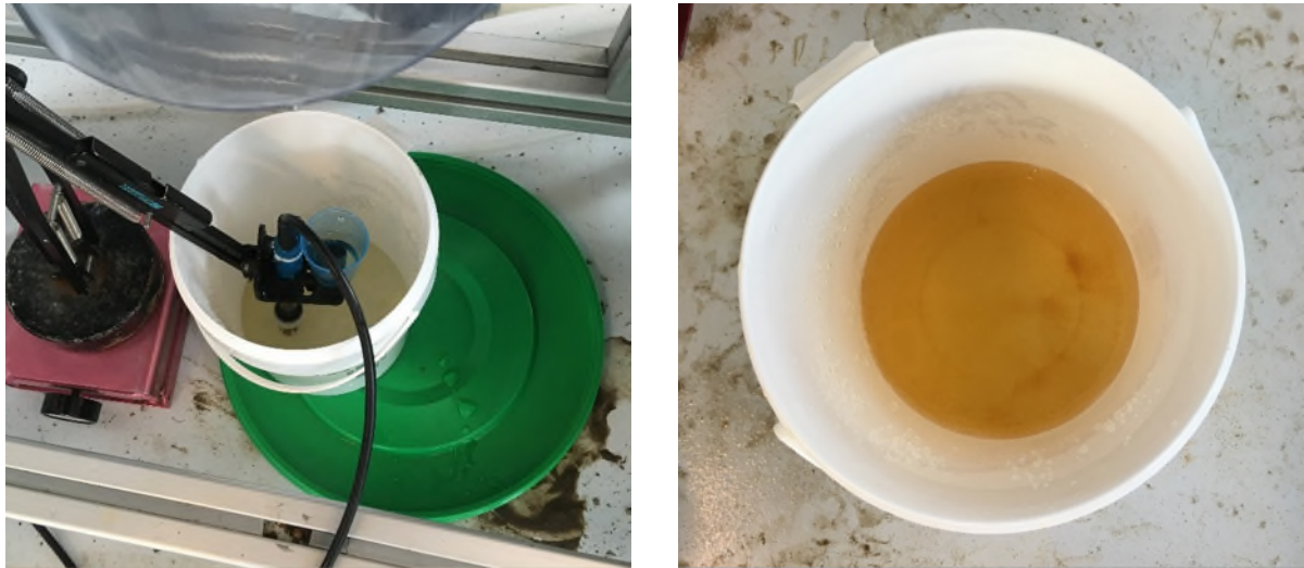
Figuur 6.3: Opstelling van de oxidatieproef. Links - de opvangemmer met de pH-meter. Naast de pH-meter staat het bekertje voor opvang van het water uit de beregingsnaalden. Rechts - de opvangemmer met de rode ijzereerslagen na afloop van de test.
