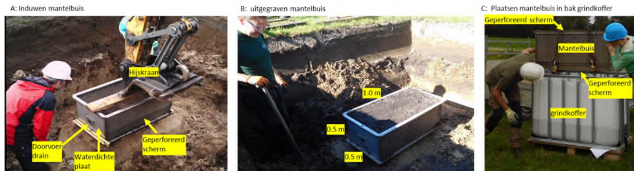
Figuur 3-3. Illustratie van wijze waarop de kolomopstelling is uitgegraven (A, B) en in de grindkoffer is geplaatst (C)
