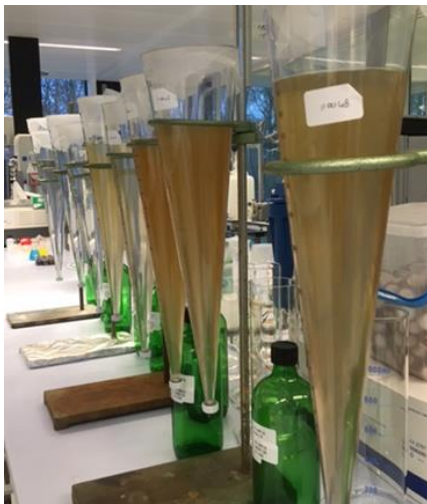
Figuur 9. Labopstelling voor het bepalen van deeltjeseigenschappen: het bezinken van deeltjesmateriaal om het volume van nat sediment te bepalen.
