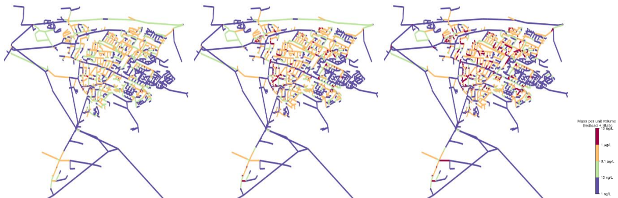
Figuur 20. Berekend sediment voor het leidingnetmodel van Castricum na een simulatietijd van (van links naar rechts) 10, 20 en 30 dagen. Leidingen buiten de figuur, vallen in de laagste sedimentklasse (<10 ng/L).
