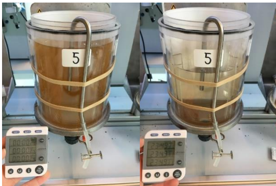
Figuur 6. Bekerglasopstelling voor bepalen van afname van de troebelheid.
