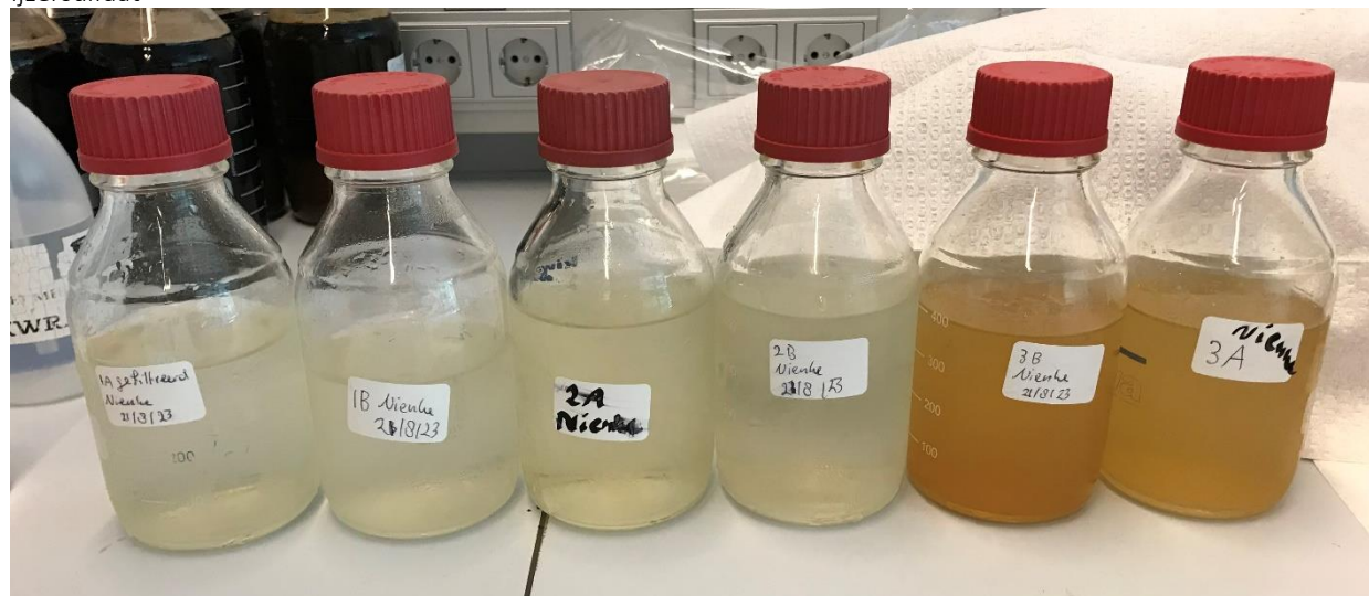
Figuur 4-5: foto's van gefiltreerde monsters van experimenten met toevoeging van ijzersulfaat, pH 4. Dosering fles 1A, 1B 16,9 mg/g; 2A, 2B: 31,7 mg/g; 3A, 3B 108,9 mg/g;
