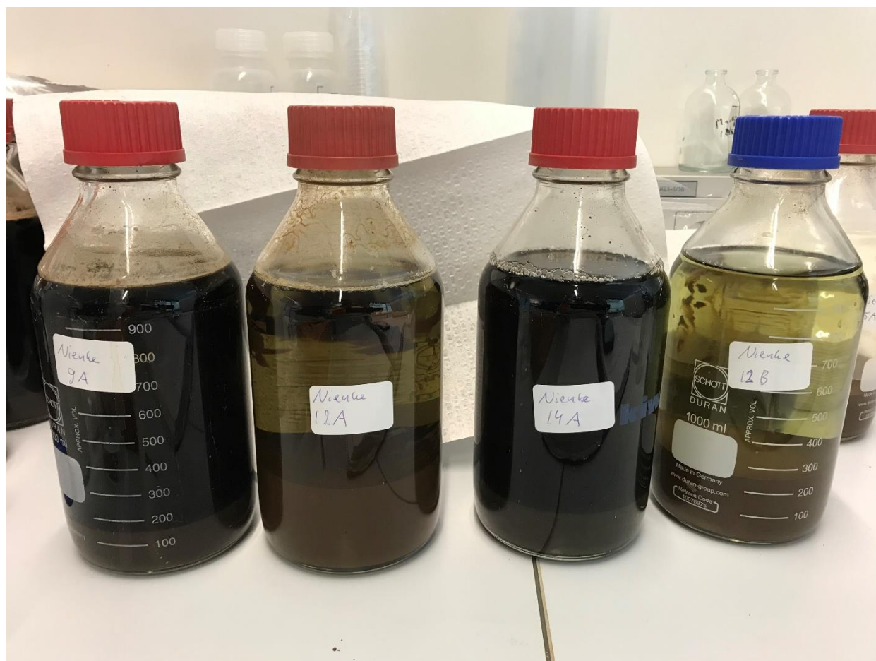
Figuur 4-1: ongefilterde monsters. 9A 0,8 g/l ascorbinezuur pH 1.6; 12A en 12B 0,4 g/l ascorbinezuur pH 2; 14A 4g/l ascorbinezuur pH2. De hoeveelheid slib en kleur zijn afhankelijk van de toegevoegde hoeveelheid ascorbinezuur en van de pH
