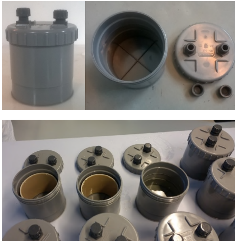
FIGUUR 2. DESINFECTIECONTAINERS VAN PVC-U. DOOR DE TWEE KRAANTJES IN DE DEKSEL KAN DE CONTAINER VOLLEDIG GEVULD WORDEN MET DESINFECTIEMIDDEL EN WORDT ALLE LUCHT VERWIJDERD.
