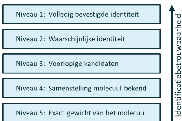
Figuur 3: Niveau (of ID levels) van de betrouwbaarheid van de identificatie van stoffen in de SNTS, opgesteld door E. L. Schymanski, J. Jeon, R. Gulde, K. Fenner, M. Ruff, H. P. Singer, and J. Hollender (2014).
