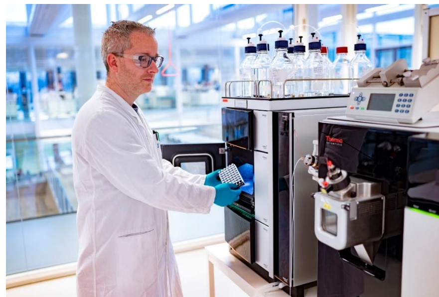
De orbitrap fusion, een hoge resolutie massaspectrometer die voor NTS gebruikt wordt.
