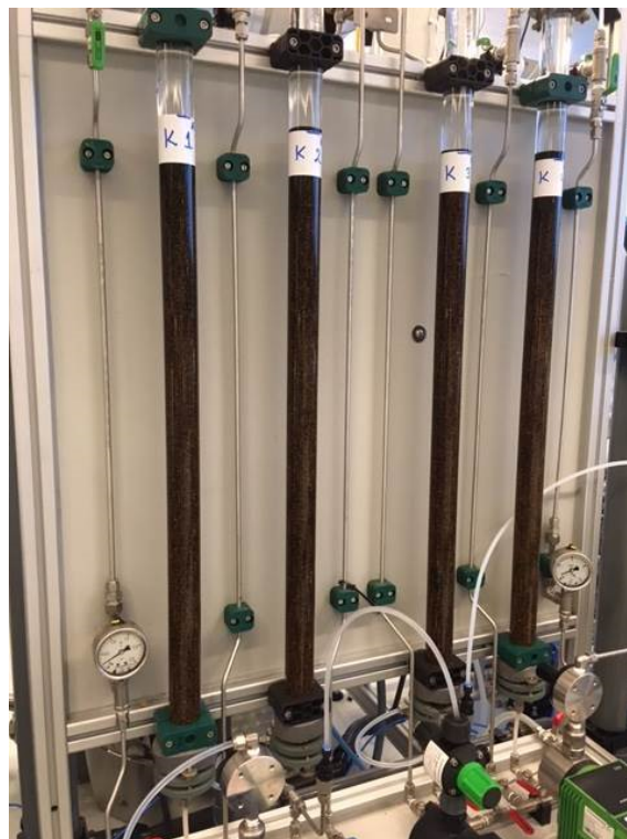
Figuur 7: Foto's van de gebruikte kolom opstelling (b) en aanvoertanks(a).
