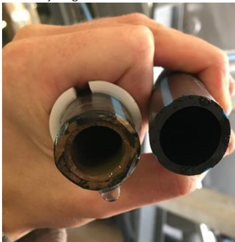
Zichtbare vervuiling van de aanvoerleiding met ijzervlokken te herkennen aan de typische bruine roestkleur
