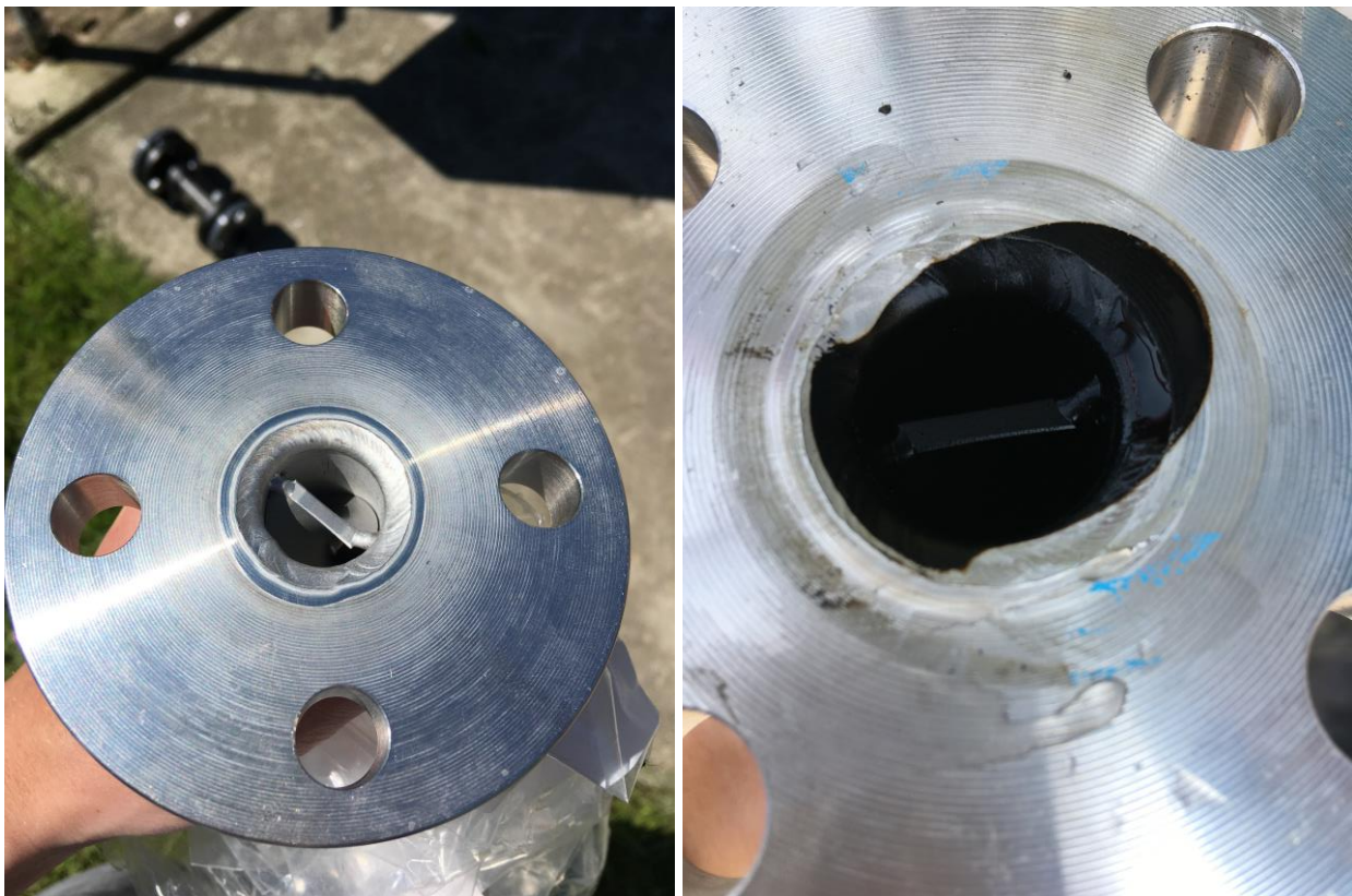
Figuur 3: Foto van aansluiting van de statische menger. Linkerfoto: voor start van de pilot, schoon materiaal. Rechts: zwart-kleurige aanslag gevormd zichtbaar bij de aansluiting van de statische menger.
