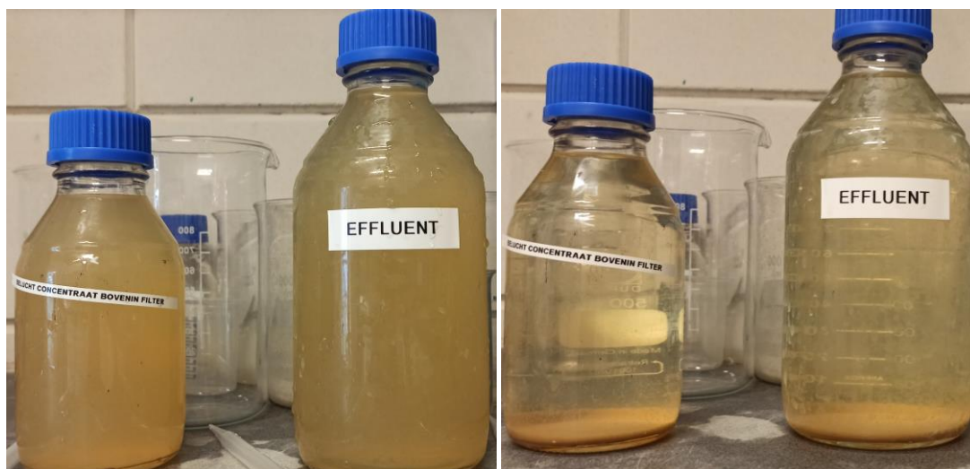
Figuur 2: Linkerkant: bovenwatersample (links) en filter-effluent sample (rechts) direct na monsternam. Rechts: bovenwatersample (links) en filter-effluent sample (rechts) na circa 18 uur bezinktijd; er heeft duidelijk bezinking van ijzeroxiden plaatsgevonden
