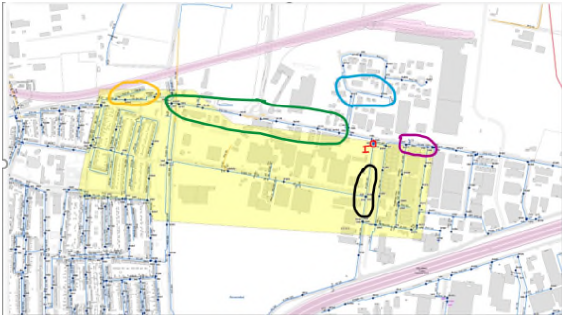
Figuur 4: Door KWR aangewezen als mogelijke locaties voor metingen gedurende test 2. Er is uiteindelijk gemeten op 2 punten in het groene gebied en 1 punt in het blauwe gebied (zie ook Figuur 5). De zwarte lijnen geven de locatie van de werkzaamheden aan. De rode cirkel is de afsluiter die is gebruikt als tracerknoop in het model.
