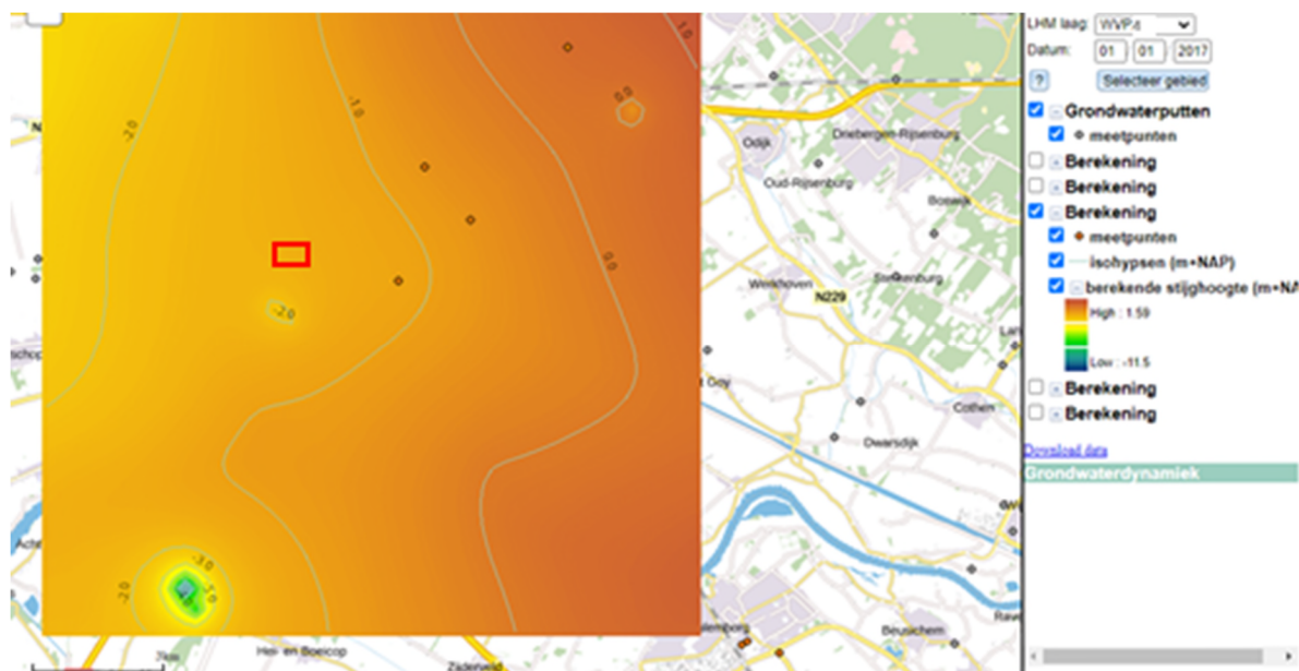
Figuur 2-4: Isohypsens (lijnen met gelijke stijghoogtes) in het tweede watervoerend pakket (WVP2, hier gegeven als WVP 4) rondom de projectlocatie (rode rechthoek), geldend voor 1-1-2017.
