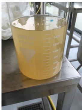
Figuur 6: effluent uit de rechter kolom van figuur 5, met 20 cm mineralenmix, niet teruggespoeld
