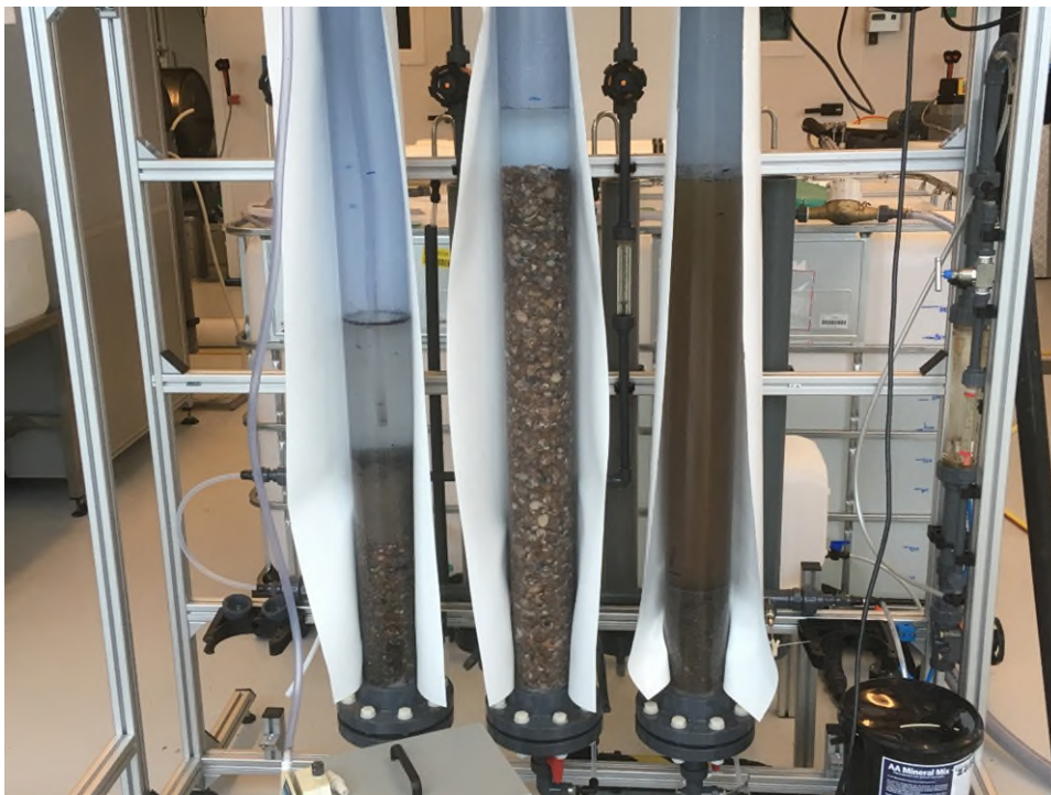
Figuur 5: Linker kolom 50 cm AA minerals na terugspoelen met schoon bovenwater; middelste kolom; 100 cm AA Ecoschelpenmix; Rechter kolom 20 cm AA minerals zonder terugspoelen met bruin bovenwater
