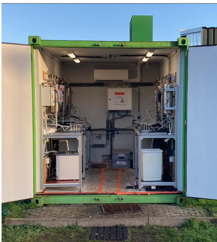
Figuur 7: ZOB-container van PWN waarin de flowcellen waren geïnstalleerd. Rechts achterin (niet in beeld) bevindt zich de steeklans waarmee continu drinkwater uit de onderliggende transportleiding wordt bemonsterd.
