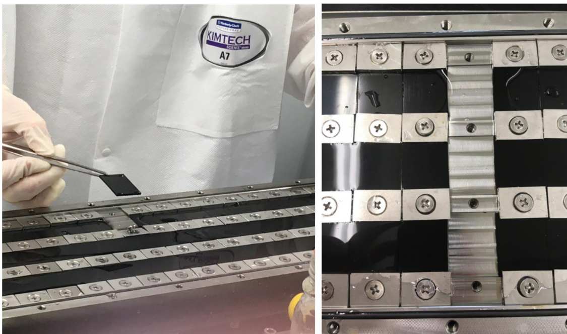
Figuur 6: Binnenkant van een flowcel met daarin EPDM-plaatjes. In de rechterfiguur is één rij plaatjes verwijderd voor monsternamname. Links vindt de monsternamname plaats.
