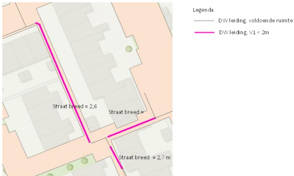
Figuur 3 Voorbeeld drinkwaterleiding met minder dan 2 meter ruimte aan de rechterkant en aan de linkerkant van de leiding
