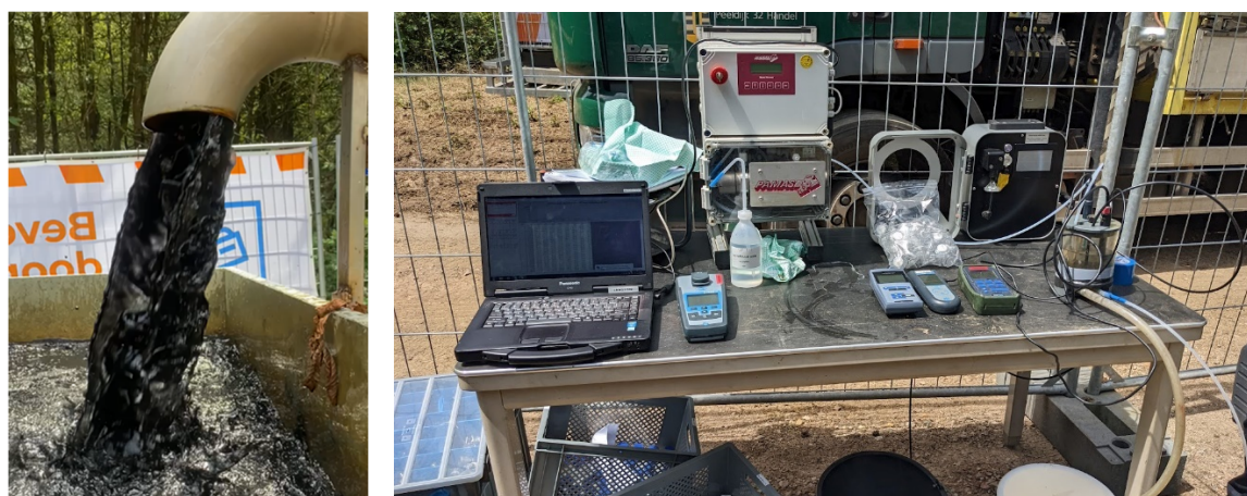
Figuur 2-8. Foto van het uit PP08 geproduceerde water (links) en verschillende gebruikte meet- en monsternameapparatuur (rechts) tijdens de regeneratie.
