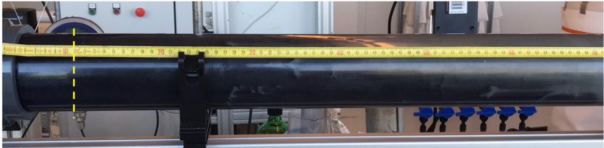
Figuur 4-5. Resultaten Experiment 1: De zandkolom na injectie van 24,4 g Cabot SA UF actief kool. Het aangebrachte filtergrind was 11 cm dik, het grensvlak tussen filtergrind en het formatiemateriaal (de boorgatwand) wordt aangegeven door de gele stippellijn.
