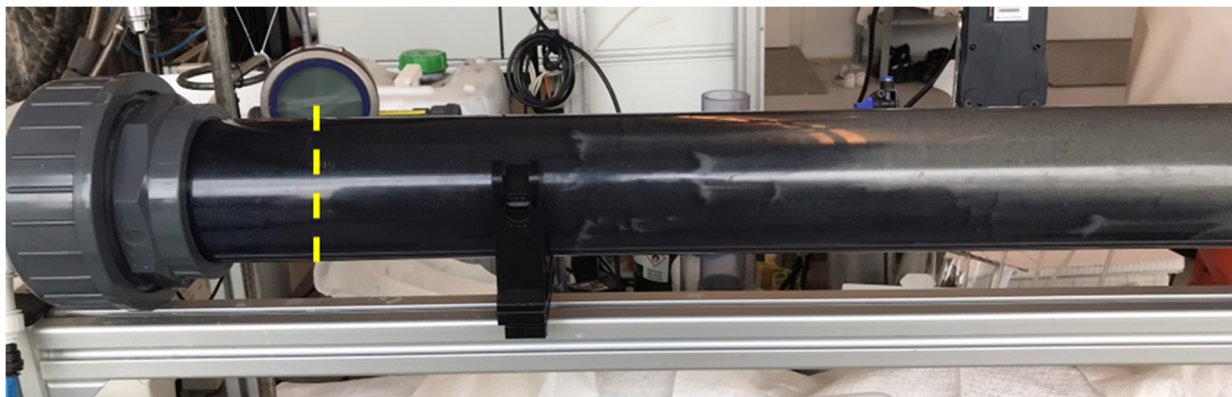
Figuur 5-4. Niet homogene verspreiding van het actief kool bij experiment 1, onder meer door de vorming van zones met minder doorlatend fijn zand gevormd door ontmenging bij. Deze gebieden met lage doorlatendheid waren visueel zichtbaar vanaf een dieptes vanaf de inlaat > 26 cm. Het aangebrachte filtergrind was 11 cm dik, het grensvlak tussen en filtergrind en het formatiemateriaal (de boorgatwand) wordt aangegeven door de gele stippellijn.
