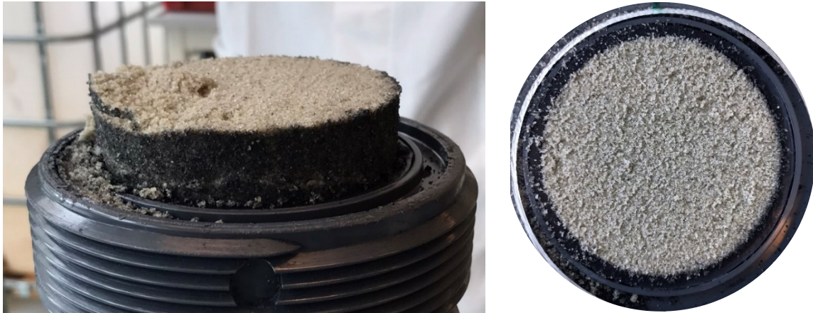
Figuur 4-14. Wandstroming zichtbaar op 23,5 cm diepte in het geëxtraheerde deel van de kolom tijdens de autopsie (links). Effecten van wandstroming zijn nagenoeg niet zichtbaar in de dwarsdoorsnede (rechts).
