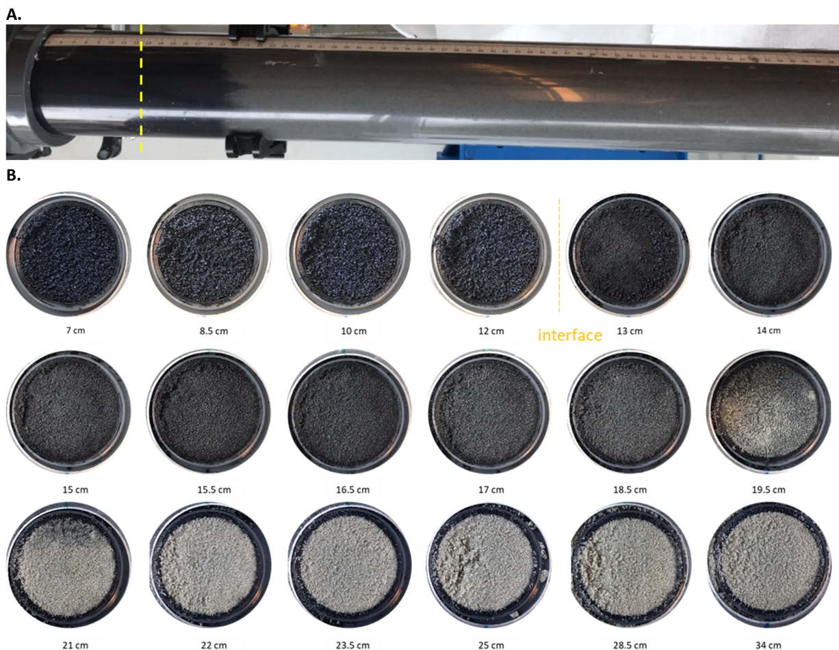
Figuur 4-13. Resultaten Experiment 5. A: Bovenaanzicht van de verspreiding van het actief kool in de bij experiment 5 gebruikte kolom na injectie van 25.3 g Cabot SA UF actief kool. Hierbij was de koalsuspensie van te voren gefiltreerd met met een 10 \mu m kaarsfilter. B: Dwarsdoorsneden van de verspreiding van het actief kool bij experiment 5 met toenemende lengte. De gele stippellijn geeft het grensvlak weer tussen het filtergrind en het formatiemateriaal (ofwel de boorgatwand) op 12,5 cm van de inlet.
