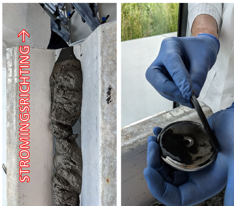
Figuur 2-18. Foto's genomen bij het legen van kolom 4 van de meeloopkolommen. Links: hoge concentratie kool in het poriewater aan het uiteinde van de kolom. Rechts: ophoping van koollurry bij de uitstroom van de kolom.
