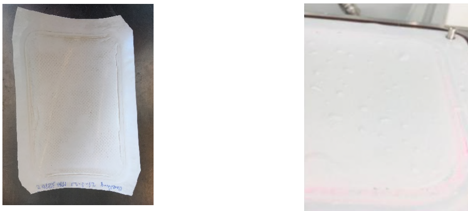
Figuur 5-4 Foto's SEPA (links) en FT-30 (rechts) membraancoupons na testen met SEPA cel
