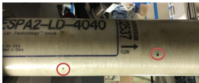
Figuur 8. Gaatjes in membraan 2 op 5-6-2020
