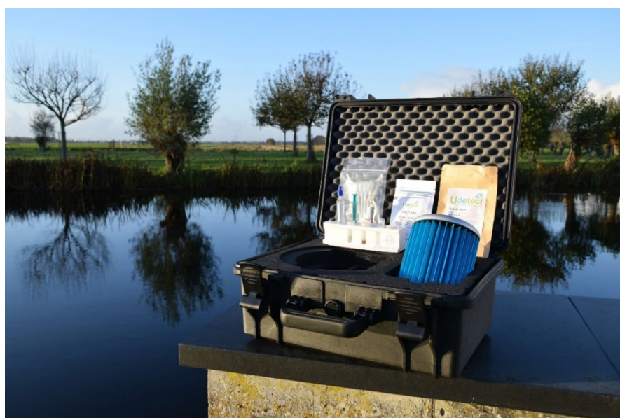
Figuur 3-4. Het Udetect mobiele qPCR systeem voor waterfiltratie, DNA-isolatie en qPCR analyse.
