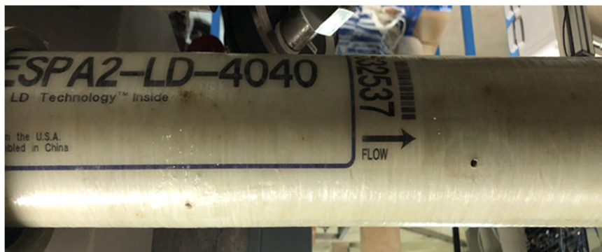
Figuur 5-10 Gaatjes in membraan 2
