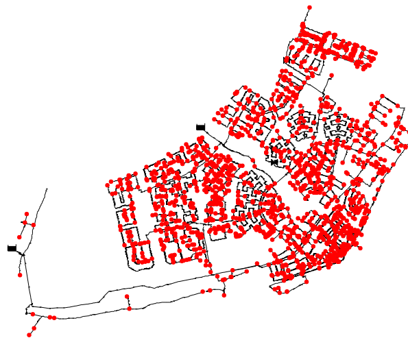
Figuur 2.6. Overzicht van knopen zonder SIMDEUM® verbruikspatronen (links) waar in scenario "1-spuien" gebruik van wordt gemaakt en knopen met SIMDEUM® verbruikspatronen (rechts) waar in scenario "1-extra Q" gebruik van wordt gemaakt.
