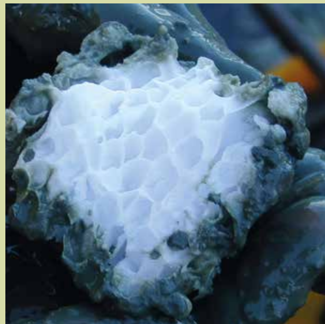
Een methaanclathraat: methaan opgeslagen in ijskristallen die zich op de bodem van de oceaan bevinden [68]
