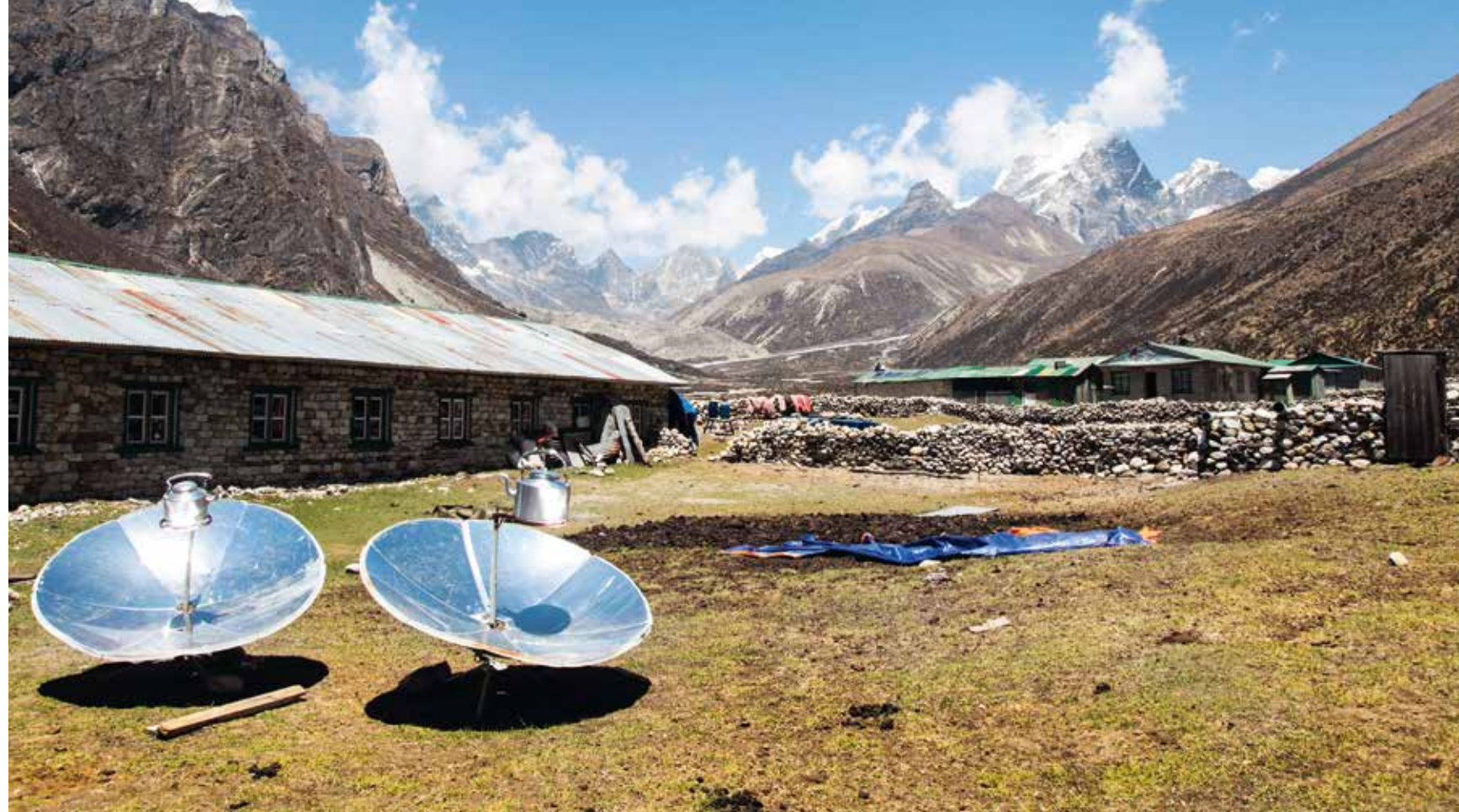
In de Himalaya worden zonneboilers gebruikt om voedsel te bereiden en water te koken
