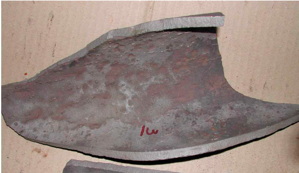
Figuur 17 Inwendig gestraald opperlak buisdeel 3
