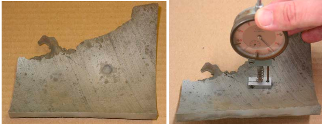
Figuur 10 Meten van de aantastingsdiepte in een put
