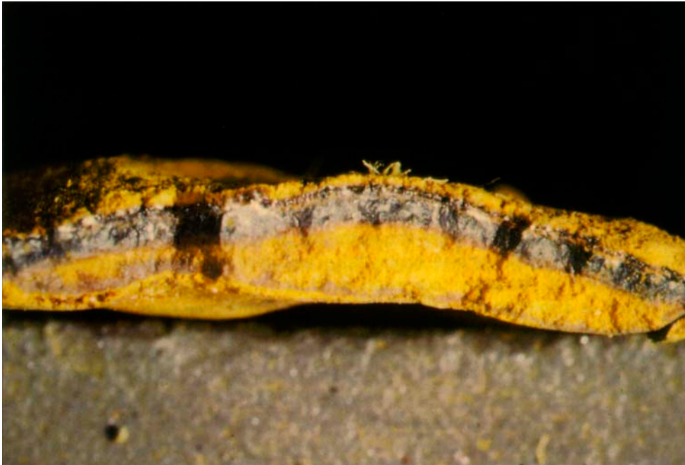
Figuur 5 Deklaagvorming in grijs gietijzer (Benjamin e.a., 1996)
