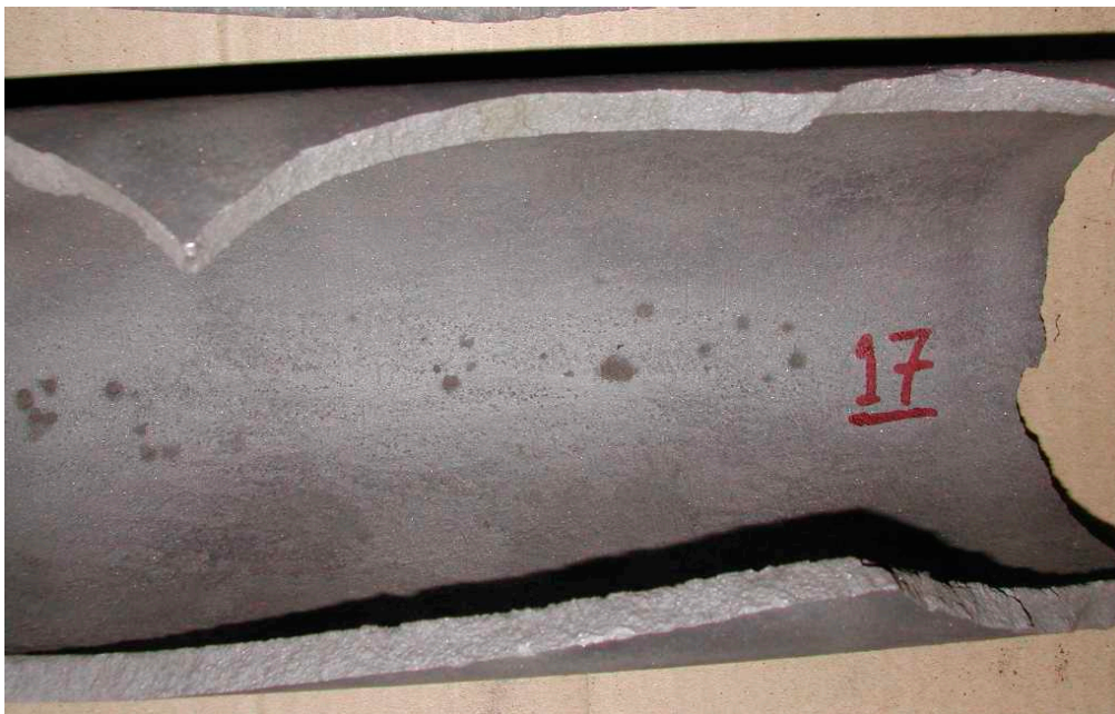
Figuur 18 Inwendig gestraald opperlak buisdeel 17
