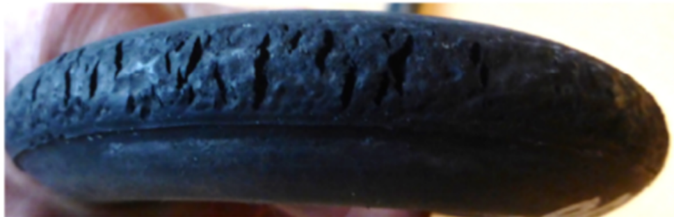
Foto 33. Positie in de buurt van 90°. Veel scheurtjes in radiale richting in de rand aan de buitenzijde
