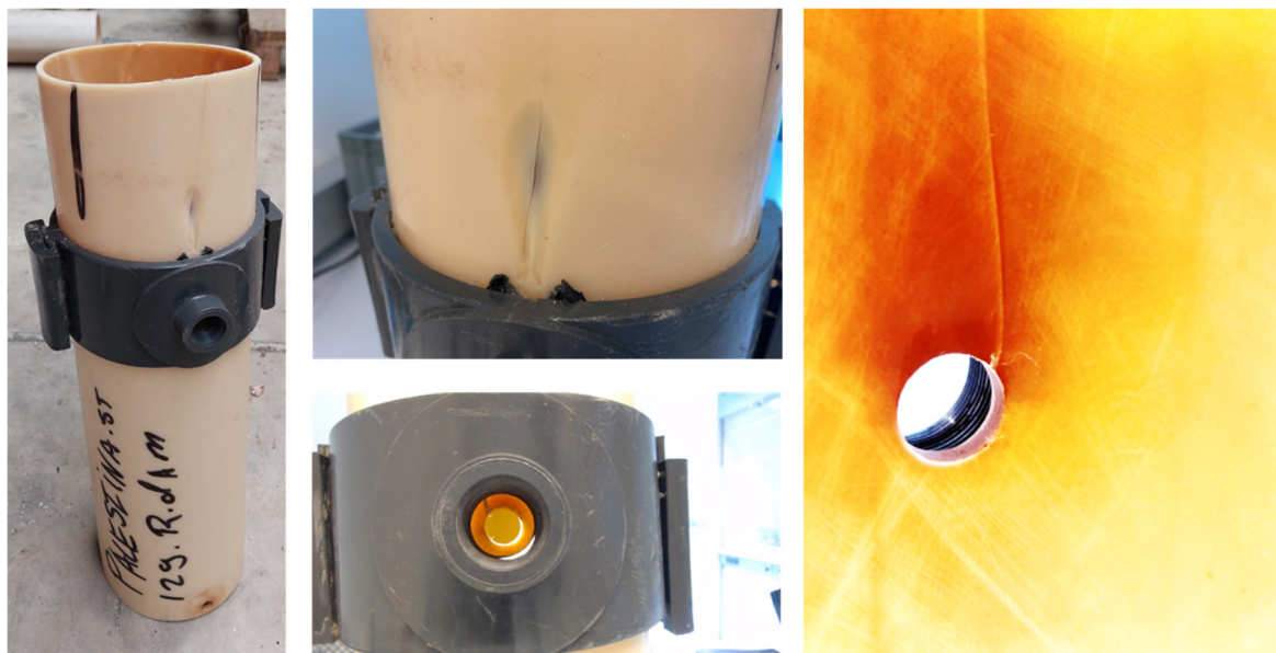
Figuur 24: (Links) Beschadigde buis naast de zadel. (Midden boven) Schade op de buis en uitsteken van rubberring vanuit zadel (Midden onder) Begin van scheur zoals gezien van buiten (Rechts) Scheur op de aanboring gezien van binnen
