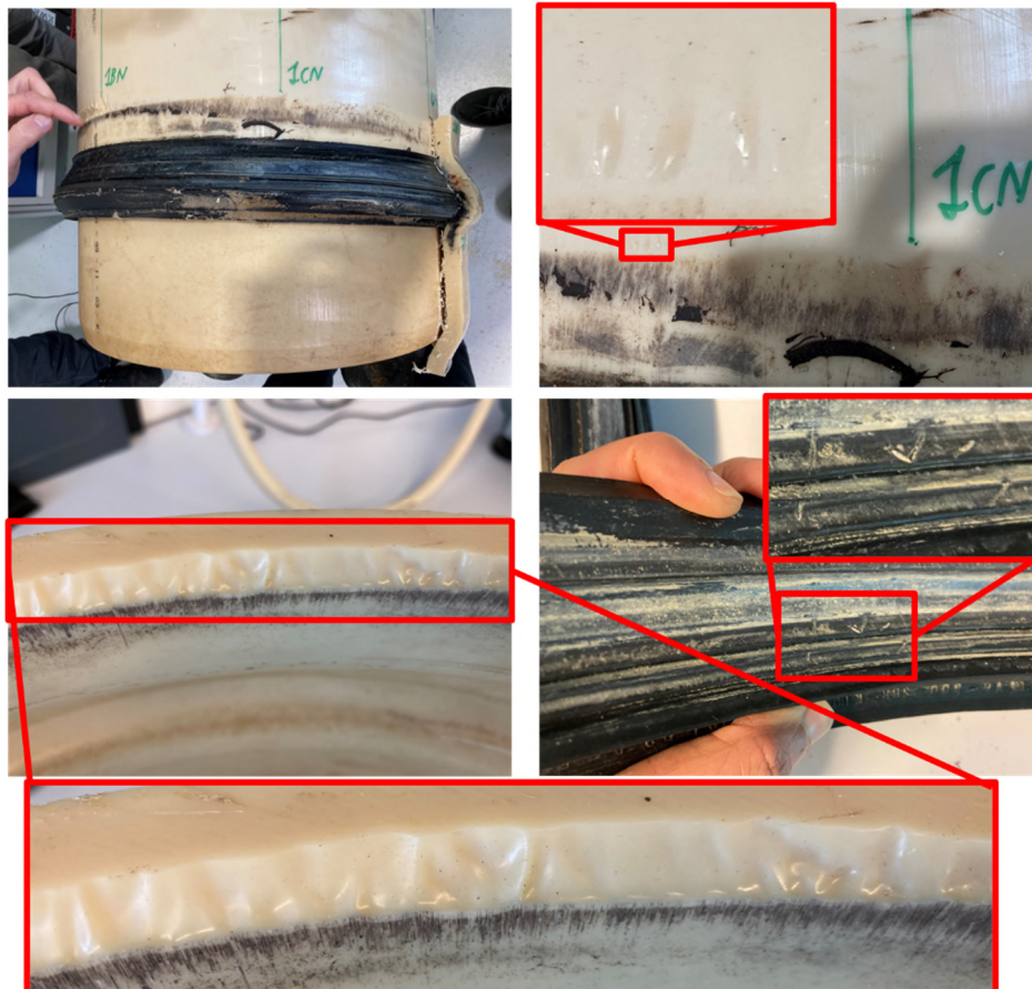
Figuur 15: Visuele analyse tijdens en na openzagen van verbinding. (Linksboven) Indruk van lokale verschuiving van rubberring dichtbij de slijtspoor. (Rechtsboven) Veel kleinere slijtsoren aan de buiswand (Linksonder) Indruk van slijtspoor aan de vinnenkant van de mof wand (Rechtsonder) Indrukken op de rubberring.
