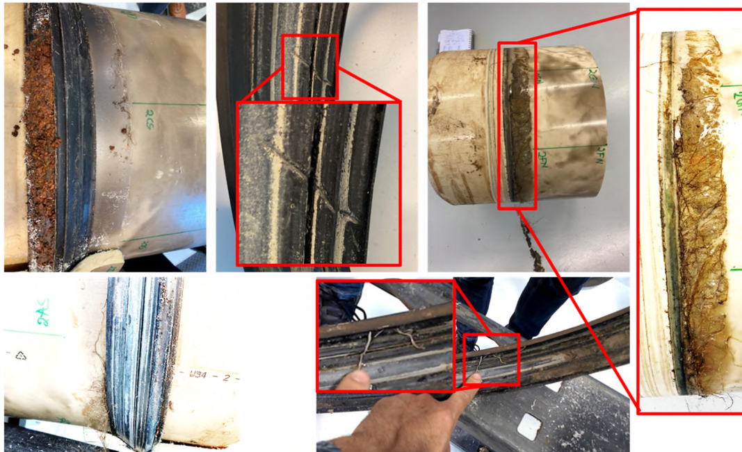
Figuur 11: Visuele analyse tijdens en na openzagen van verbinding (Linksboven) Zand en ijzer aan de waterkant van de ring (Midden boven) Indruk op de rubberring (Rechtsboven) Capillaire wortelen op de buiswand (Linksonder) Wortelen die onder de ring vast zitten (Rechtsonder) Wortel die in de ring zat.
