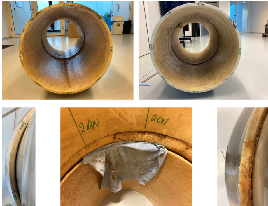
Figuur 10: Visuele analyse voor openzagen van verbinding. (Links en rechts boven respectievelijk) Asymmetrie in buis ligging binnen mof gezien van S en N kant respectievelijk. (Linksonder) Relatief grote gat tussen buis en mof buitenkant FG-S. (Midden onder) Relatief grote gat tussen buis en mof binnenkant BC-S. (Rechtsonder) Aanwezigheid van wortelen tussen mof en buis.
