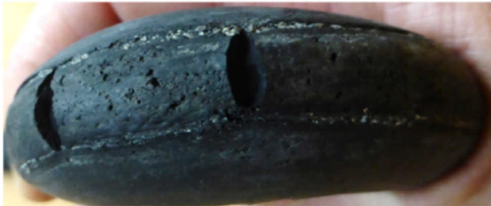
Foto 34. Positie in de buurt van 180°. Grote scheuren in radiale richting in de rand aan de buitenzijde zichtbaar bij buigen van de ring. Ook kleine gaatjes zichtbaar
