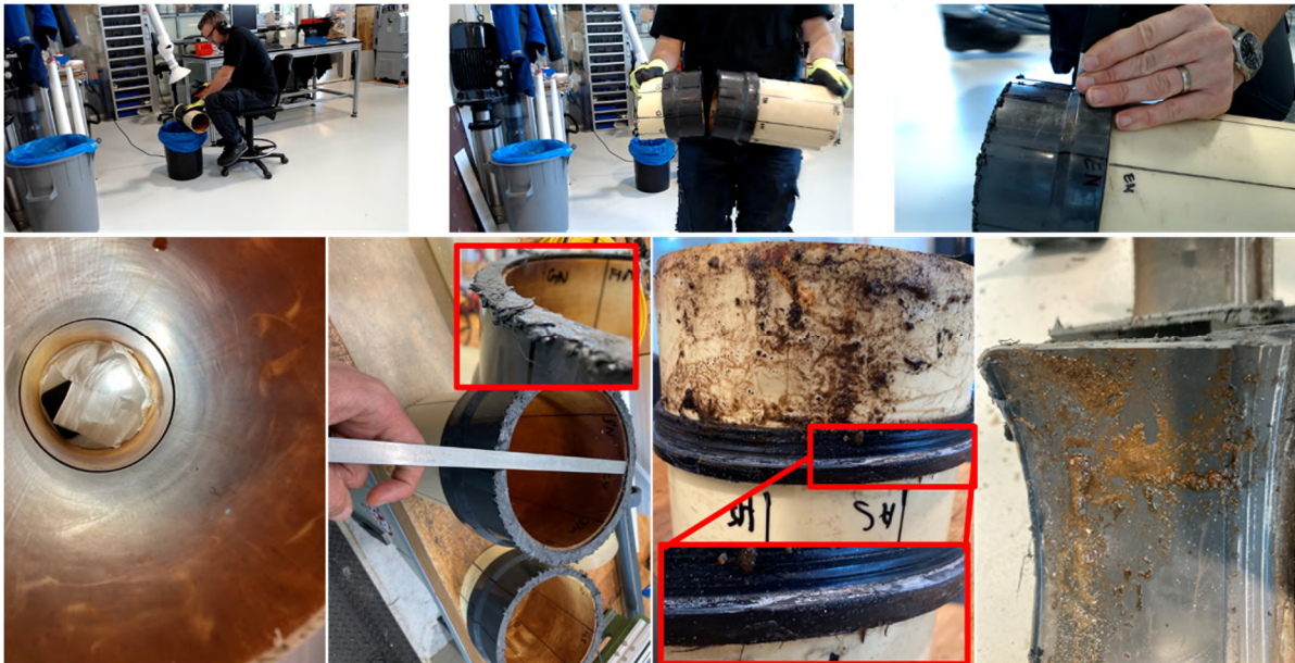
Figuur 25: (Boven rij) Procedure van open maken van mof. (Beneden rij, links) Binnenkant van de buis-mof. (Beneden rij, midden links) Manier om mate van verschuiving van buis in de mof af te meten. In de inset wordt de ruwheid als gevolg van het smelten van PVC aangetoond (Beneden rij, midden rechts) Slib aan de onderkant van de buis. In de inset wordt vet aan de ring aangetoond. (Beneden rij, rechts) Slib aan de onderkant van de mof.
