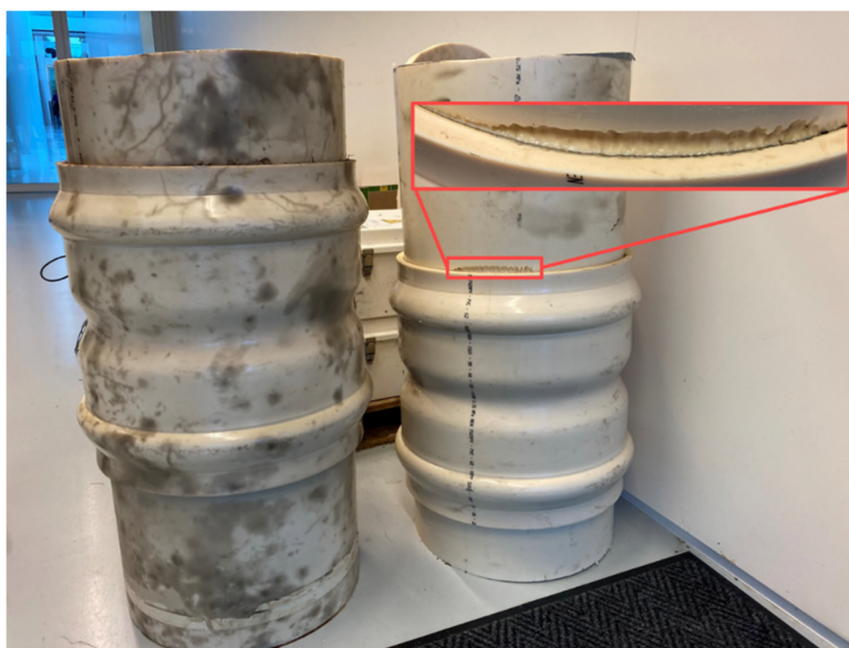
Figuur 6: Twee lekkende PVC verbindingen vanuit de Vitens voorzieningsgebied met diameter 500 mm. Degene aan de rechterkant heeft een opvallende erosie op de oppervlakte van de buis.
