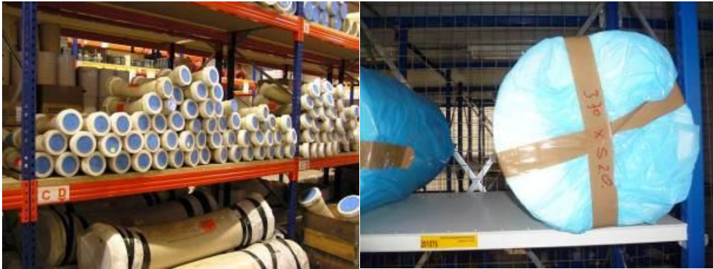
Foto 2.2.3 Bescherming van leidingmaterialen tijdens opslag in een magazijn (foto's Vitens).
