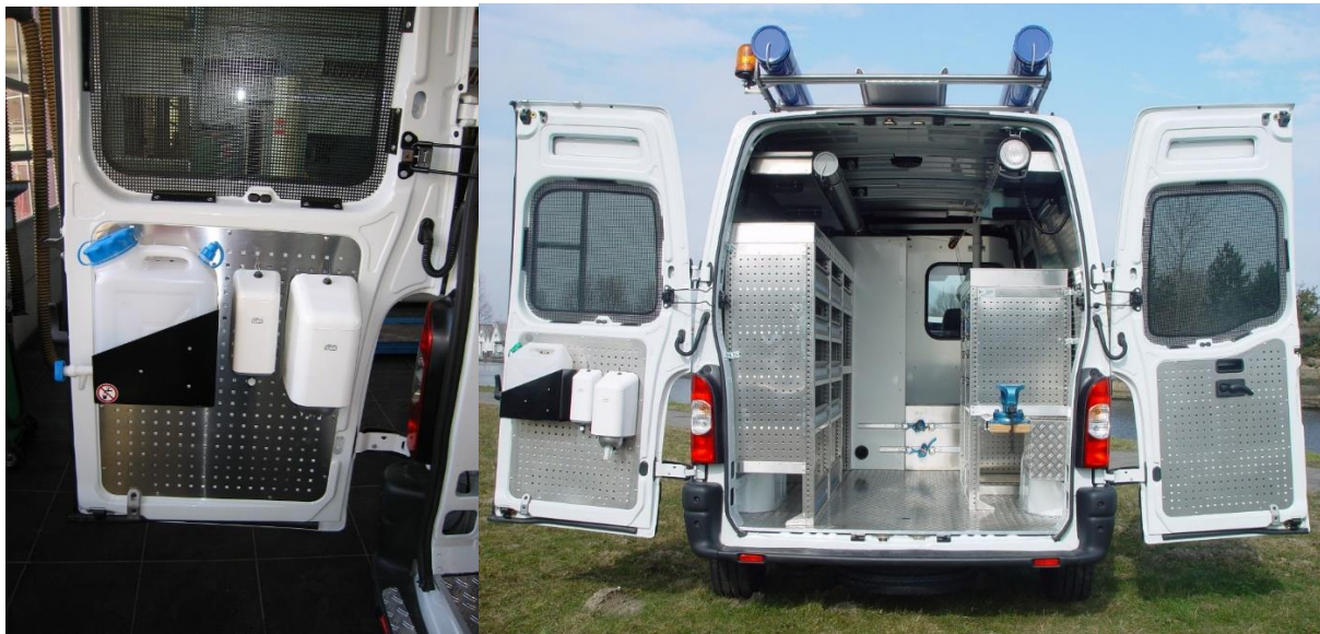
Foto 1 (Voorzieningen in) een monteursbus (ten behoeve van hygiënisch werken) (foto's Vitens).
