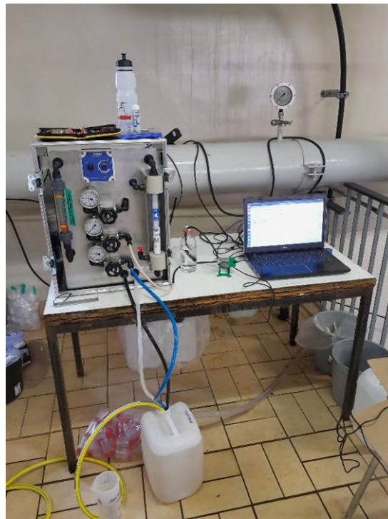
Figuur 20 Experimentele holle vezel NF setup en voedingsvat. Het voedingsvat is de witte bidon waarin het onbeluchte grondwater toekomt via de gele Gardena slang. Het voedingsvat werd continu verversd en was voorzien van een overloop, zijnde de slang die onder de tafel doorloopt.
