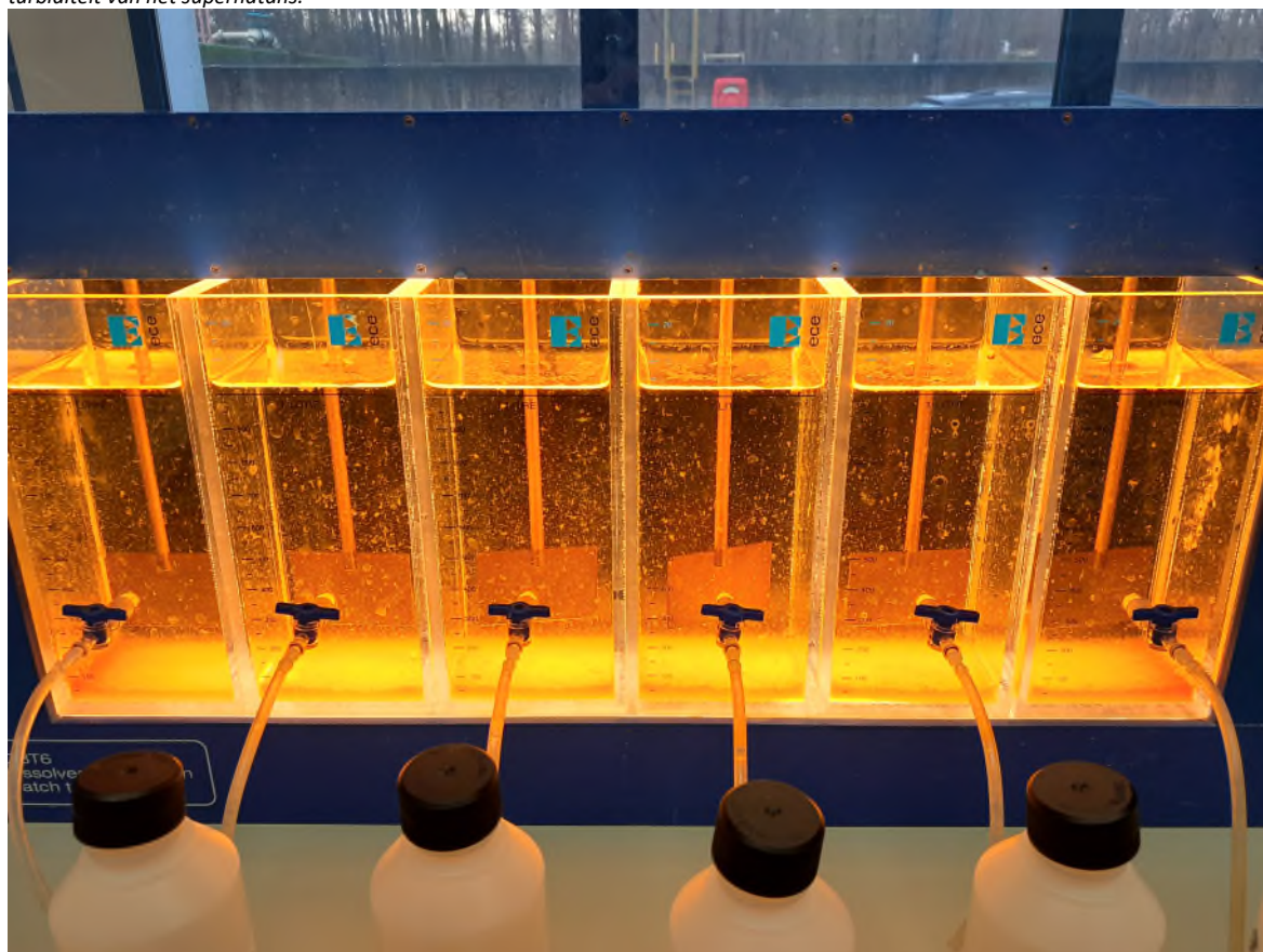
Figuur 12 Coagulatietesten met \text{FeCl}_3 en \text{H}_2\text{SO}_4 , tijdens bezinking. Bemerk de grote hoeveelheid slib op de bodem van de bekertjes en de lage turbiditeit van het supernatans.
