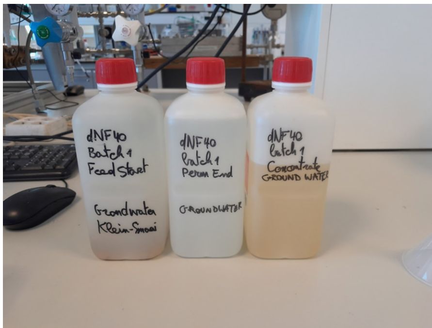
Figuur 26 Stalen van initiële voeding, de laatste liter permeaat en het concentraat van de eerste batch. Wat opvalt is de laag bezinksel in het staal van de initiële voeding en de sterk bruine kleur van het concentraat.
