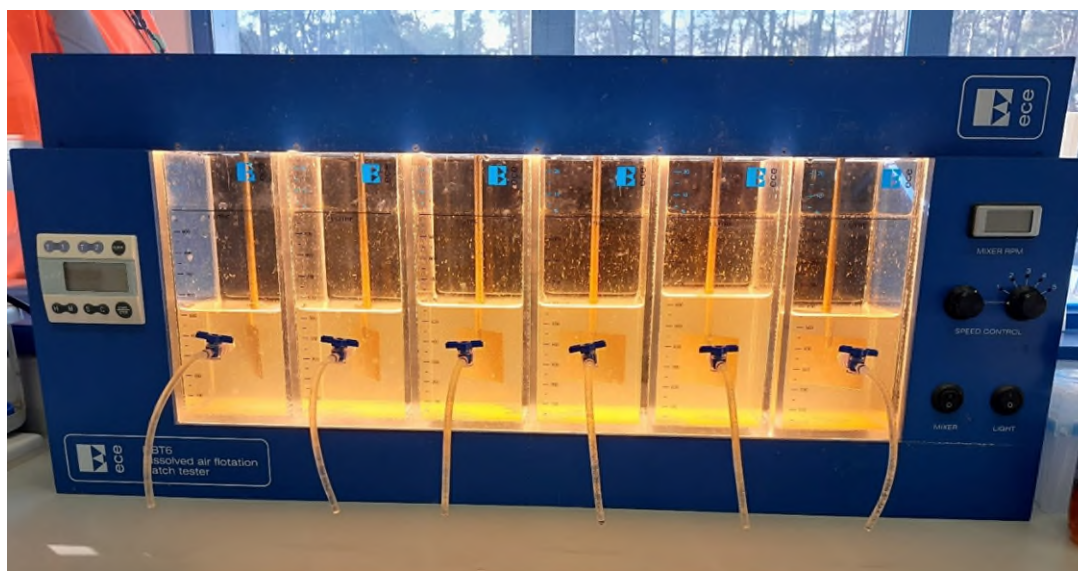
Figuur 11 Einde van coagulatietest met polyDADMAC, waarin gebrekkige bezinking optrad. Een kleine fractie van de gevormde vlokken zijn bezonken, het grootste deel van de vlokken bleef in suspensie waardoor de turbiditeit hoog bleef.
