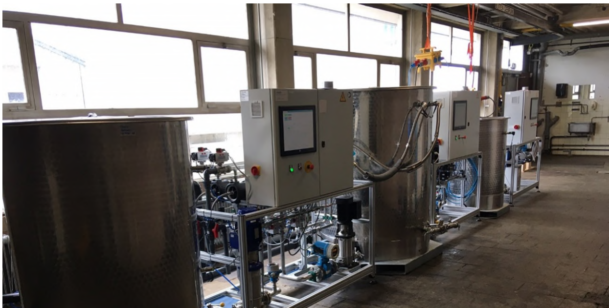
De fractioneringsopstelling op productielocatie Andijk.
