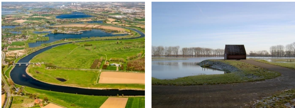
Figuur 2-1 Pompstation Roosteren bij regulier waterpeil van de Maas (links) en overstroming van de uiterwaard rond de radiaalput bij pompstation Roosteren (rechts). Deze radiaalput is gebouwd op een terp. Bron: E. De Bruin (WML)
