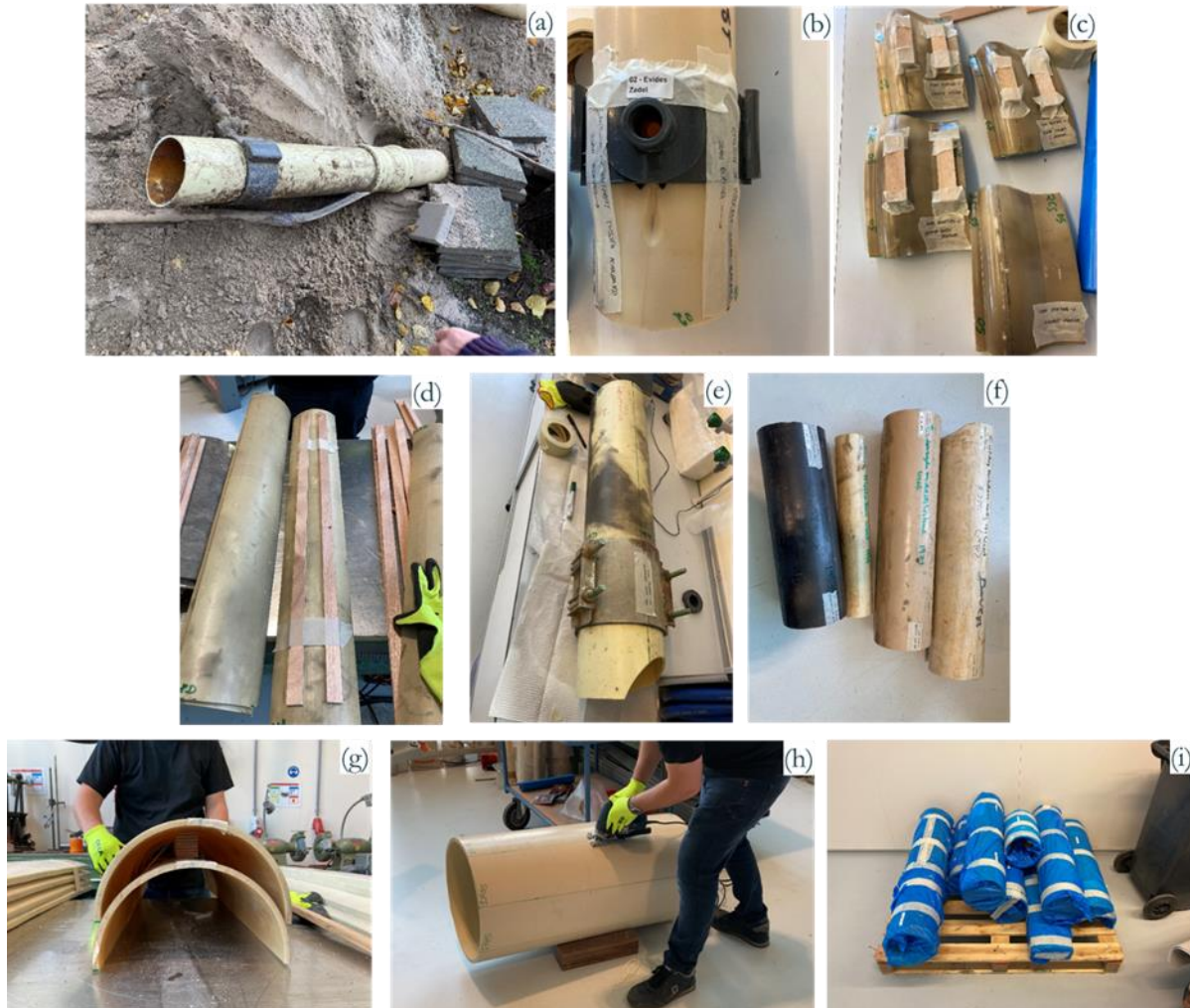
Figuur 1. (a) Uitname van een proefstuk tijdens een saneringsproject. (b) Markering van meest interessante gebied op een proefstuk met een gescheurd zadel. (c) In stukken gezaagde steekmof die tot één proefstuk zullen worden gestapeld met houten tussenstukken. (d) In repen gezaagd buisdeel dat tot één proefstuk gestapeld zal worden met houten tussenstukken. (e) Proefstuk met reparatieklem. (f) Proefstukken die in zijn geheel in CT-scanner geplaatst kunnen worden. (g) Buisdelen die doormidden worden gezaagd hebben een relatief dik houten tussenstuk nodig om de repen te kunnen stapelen. (h) Zagen van het grootst proefstuk. (i) De eerste tien proefstukken, verpakt en verzameld op een pallet.
