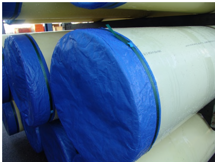
Foto 11 en 12 Bescherming van leidingmaterialen tijdens opslag in het magazijn (checklist 3.5, onderdeel 1).
