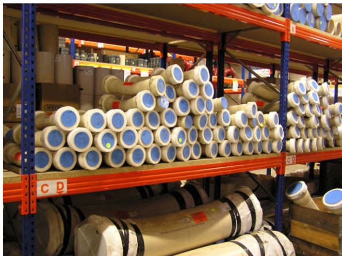
Foto 11 en 12 Bescherming van leidingmaterialen tijdens opslag in het magazijn (checklist 3.5, onderdeel 1).
