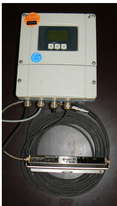
Figuur 3-1 Weergave van een Proline Prosonic volumestroommeter.
