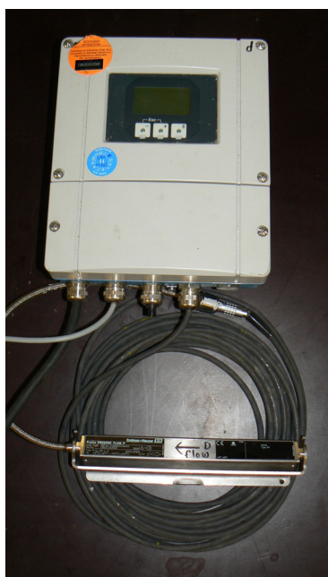
Figuur 4-1 Weergave van een Proline Prosonic volumestroommeter.
