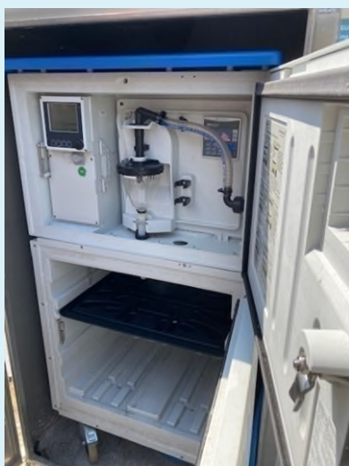
Figuur 4: monsterkast voor regenwateropvang
