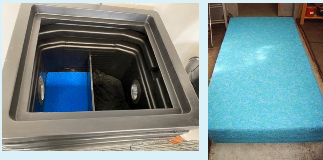
Figuur 8: regenwateropvangsysteem met twee compartimenten. Links opvangsysteem, rechts 'Japanse wol'.
