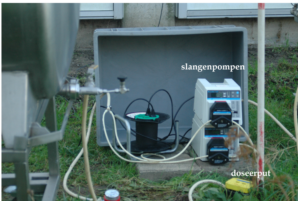
Figuur 2.3 Foto's van de doseertanks en slangenpompen waarmee de oplossingen vanuit de doseertank in de doseerput werd gepompt.
