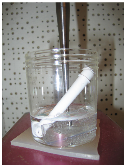
Figuur 3.6. HES behandeling van de biofilmsuspensie met borstel en biofilmmonster
