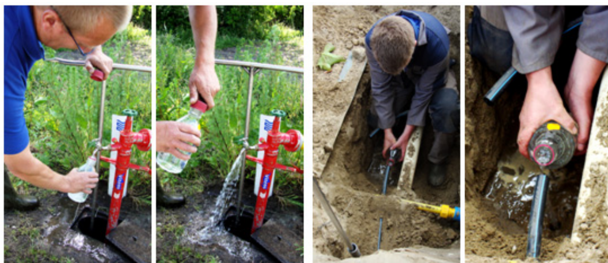
Figuur 4. Verzameling van watermonsters: via de brandkraan (links, locatie Nijbroekseweg, Apeldoorn) en uit de afgebroken leiding (rechts, locatie Orderparkweg 5, Apeldoorn). Bij de bemonstering is er voor gewaakt dat de materialen niet met de handen werden aangeraakt om contaminatie van buitenaf te voorkomen.
