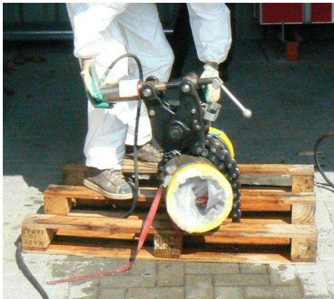
Figuur 4-2 Knippen AC buisdeel voor de fenolftaleïne-test
