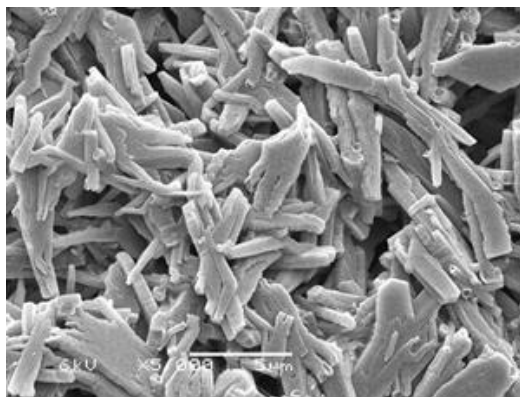
Figuur 5.1: SEM beeld van het met EFC behandeling van ingedikt RO concentraat verkregen zout. Schaalstreep geeft 5 \mu\text{m} weer.
