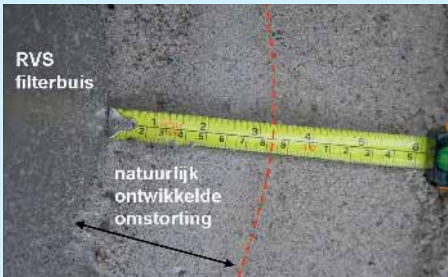
Een natuurlijk ontwikkelde omstorting rondom een RVS-wikkeldraadfilter.
