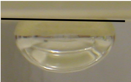
Figuur 4.4-4: Opname van een druppel met captive bubble methode
