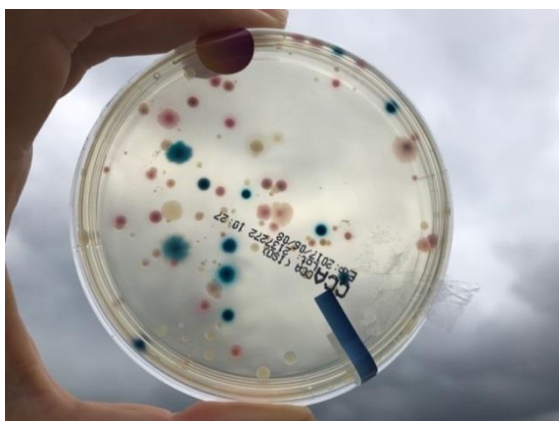
Figuur 2.7. Links: Het aantal E.coli-bacteriën wordt bepaald met behulp van een kweekmethode waarbij het watermonster wordt aangebracht op een voedingsbodem voor bacteriën in een petrischaaltje (foto van deelnemer Ingeborg). Rechts: In het observatie-experiment worden met behulp van een zoekkaart objecten waargenomen die van invloed zijn op de waterkwaliteit en vaak zelf ook beïnvloed worden door waterkwaliteit. Hierbij worden onder andere watervogels geteld (uitsnede foto van deelnemer Rhyzius).
