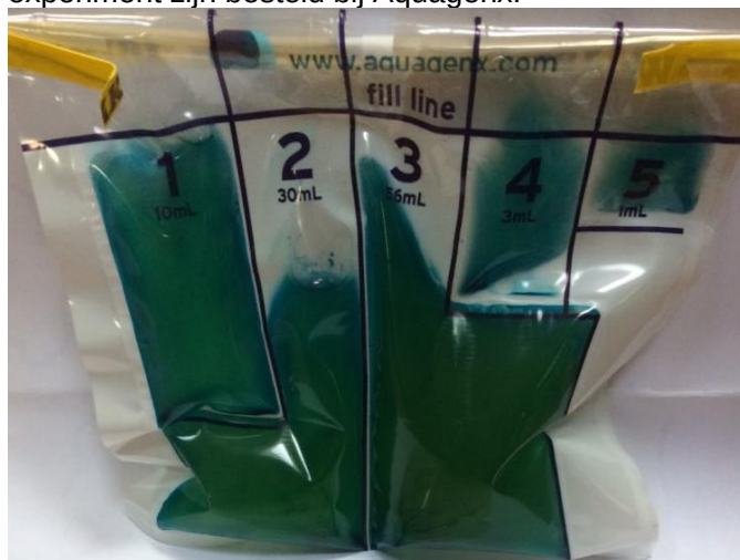
Figuur 2.9: Links: Het watermonster in de verschillende compartimenten kleurt groen indien er levensvatbare E.coli -bacteriën in het water aanwezig zijn (Uitsnede foto van deelnemer Woonbootmuseum). Door de verkleuring te vergelijken met de zogenaamde MPN-tabel (rechts) kan het aantal E.coli -bacteriën worden bepaald (Tabel van Aquagenx).
