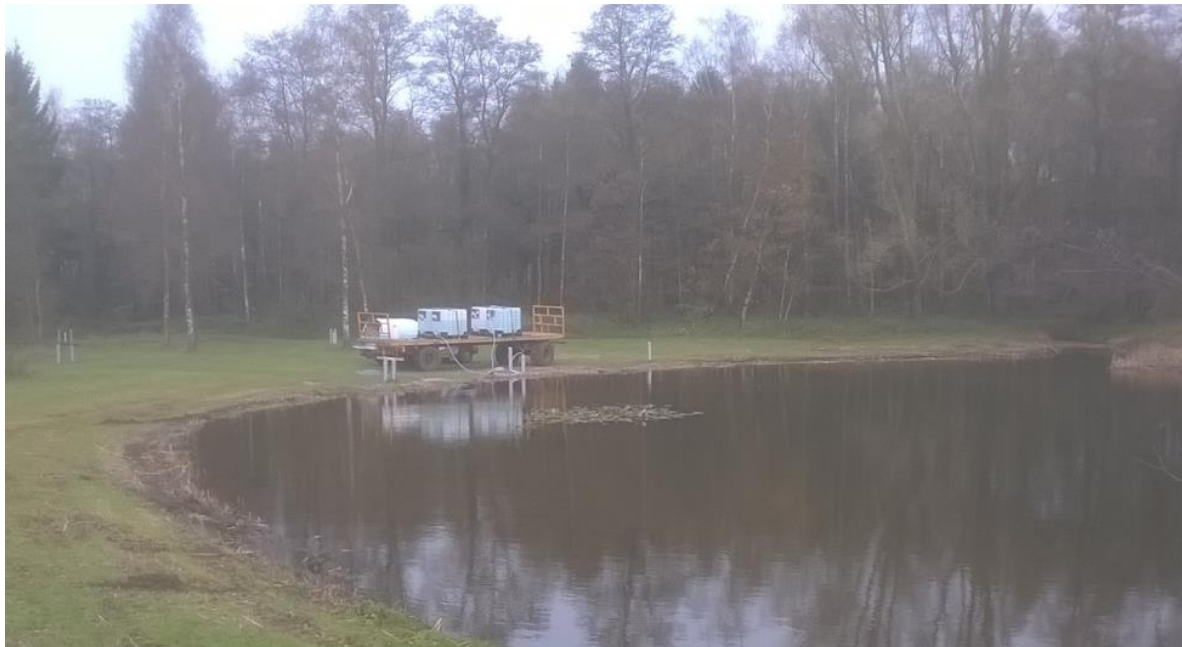
Dosering van tracervloeistof in een langs de oever ingegraven drainbuis bij infiltratieplas 'Oog van Zonderwijk' op winveld Olden Eibergen
