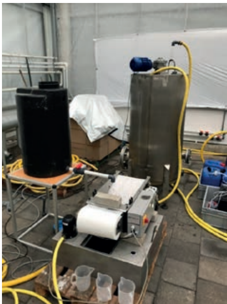
Figuur 8 Pilotinstallatie voor zuivering Standaard Water met PAC. Rechts achterin het reactorvat, links het vlokvat, rechtsvoor het doekfilter.
