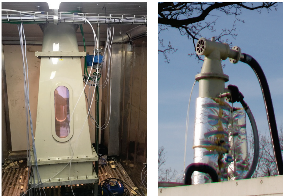
FIGUUR 2-3 INSTALLATIE VAN DE REACTOR IN DE CONTAINER MET RECHTS DE BUITEN DE CONTAINER UITSTEKENDE BOVENRUIMTE
