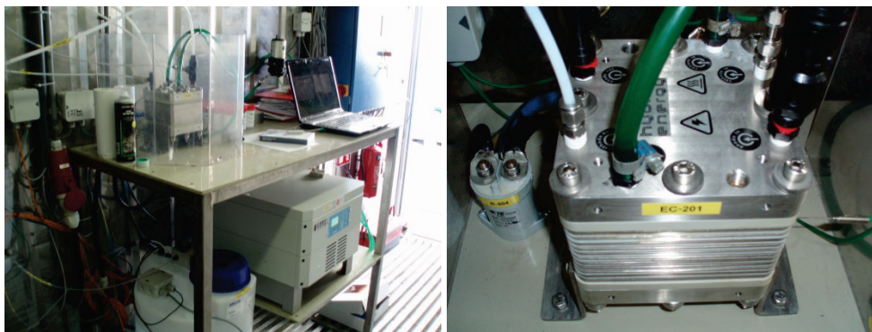
FIGUUR 2-4 ELEKTROLYSECELL MET DAARONDER DE VOORRAAD ULTRAPUUR WATER
