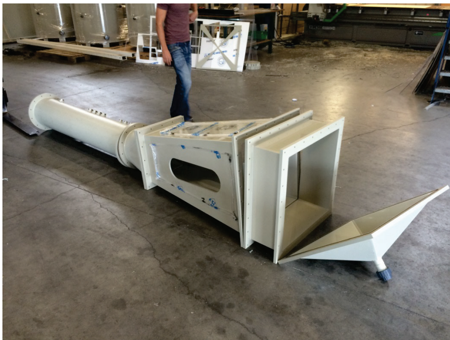
FIGUUR 2-2 DE REACTOR IS OPGEBOUWD UIT VIJF SEPARATE ONDERDELEN
