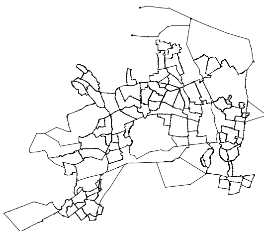
FIGUUR 4-2 STREEFSTRUCTUURMODELLEN (NIET OP SCHAAL) A) VOLLEDIG MODEL (P-S-T) GRUBBENVORST (WML), B) VERDUND MODEL KROMMENIE (PWN) EN C) UITEINDELIJKE NETVORM VAN DE STREEFSTRUCTUUR (P-S) MODEL HELMOND (BRABANT WATER) TERTIAIR WORDT NIET WEERGEGEVEN.
