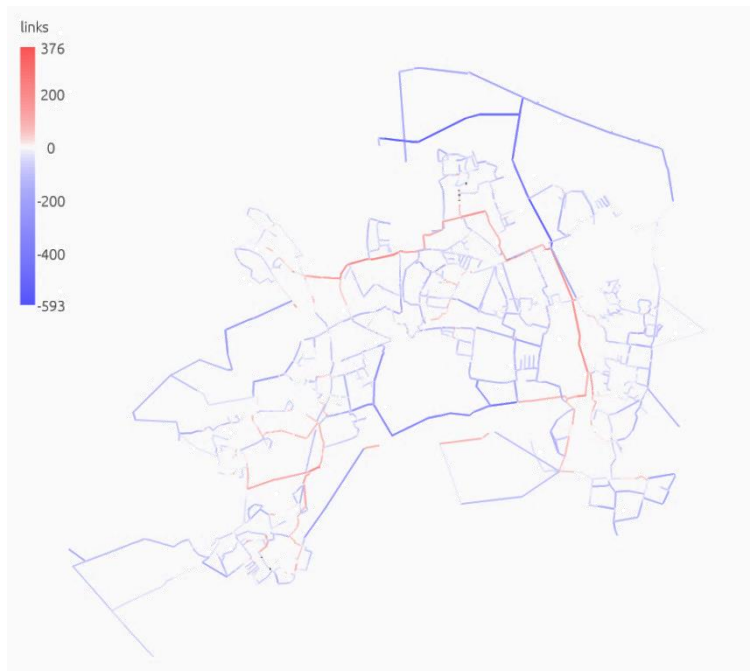
FIGUUR 17. VERSCHIL IN LEIDINGDIAMETERS TUSSEN HET HUIDIGE LEIDINGNET EN HET GEOPTIMALISEERD ONTWERP VOOR HELMOND-MIERLO. DE KLEURENSCHAAL GEEFT DE TOENAME (ROOD) OF AFNAME (BLAUW) VAN DIAMETERS AAN. HOE DONKERDER DE KLEUR HOE GROTER HET VERSCHIL. DIAMETERS DIE NIET WORDEN VERANDERD ZIJN IN ZWART.
