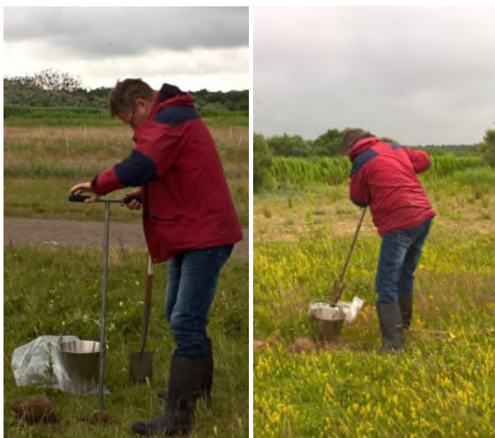
FIGUUR 10. BEMONSTERING DUINZAND DOOR MIDDEL VAN 7 GRONDBORINGEN.
