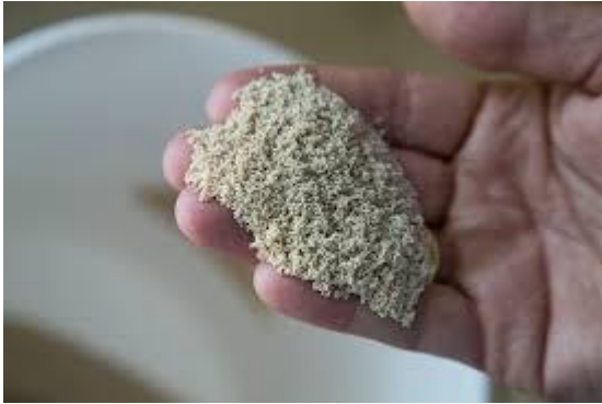
Afbeelding 1. Voorbeeld van een kationwisselaar/hars [10]
