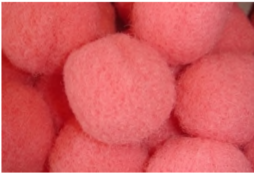
FIGUUR 6-3: DE ROZE BALLETJES GEMAAKT VAN SYNTHETISCHE VEZELS DIE IN HET FUZZY-FILTER ZITTEN (BRON: : HTTP://WWW.BOSMAN-WATER.NL/NL/PRODUCTEN/ZUIVERINGSINSTALLATIES/FUZZY-FILTER )
