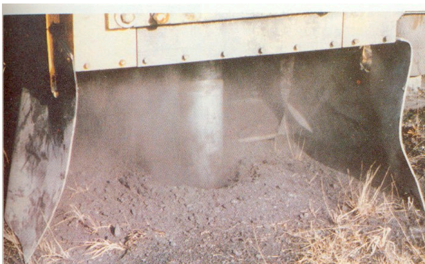
Figuur 2.3 De losgeboorde deeltjes worden het boorgat uitgeblazen
