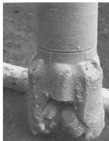
Figuur 2.4 gebruik maken van een dikke boorstang
