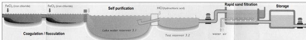
FIGURE 6 SCHEMATIC OVERVIEW OF PRETREATMENT AT LOENDERVEEN
