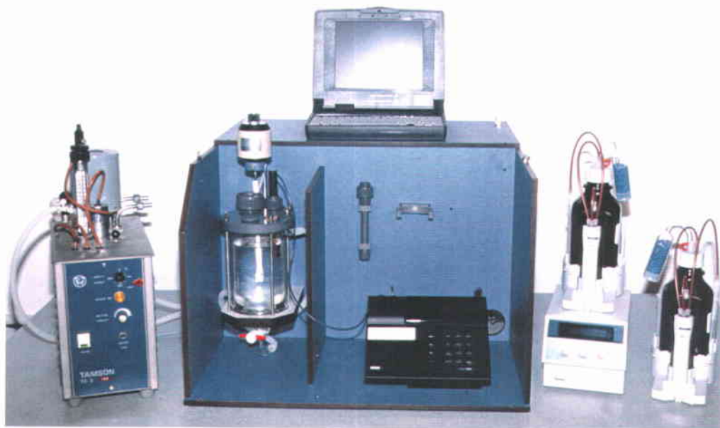
Figuur 2 Foto van de Kiwa-opstelling voor de meting van het nucleërend vermogen
