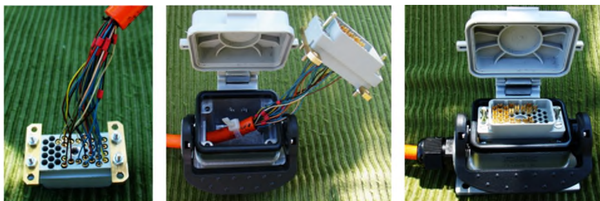
Figuur 33-14 Nieuwer type EDAC 516connector (foto's Waternet).
