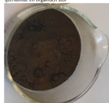
Figuur 32-13 Foto van biofilmmonster dat, ondanks zwarte kleur, overwegend uit ijzerhydroxiden bestaat [van der Schans, 2019].
