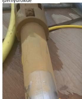
Figuur 32-12 Foto's van pompen met rode neerslag ondanks verschillende chemische samenstelling. A = Meijendel, Dunea (M. v.d. Schans); B = Brabant Water [Stuyfzand et al., 2016]; C= Bronbemaling (M. v.d. Schans).
