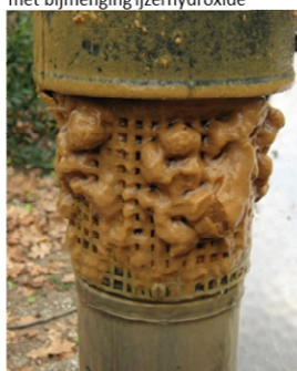
Figuur 32-12 Foto's van pompen met rode neerslag ondanks verschillende chemische samenstelling. A = Meijendel, Dunea (M. v.d. Schans); B = Brabant Water [Stuyfzand et al., 2016]; C= Bronbemaling (M. v.d. Schans).
