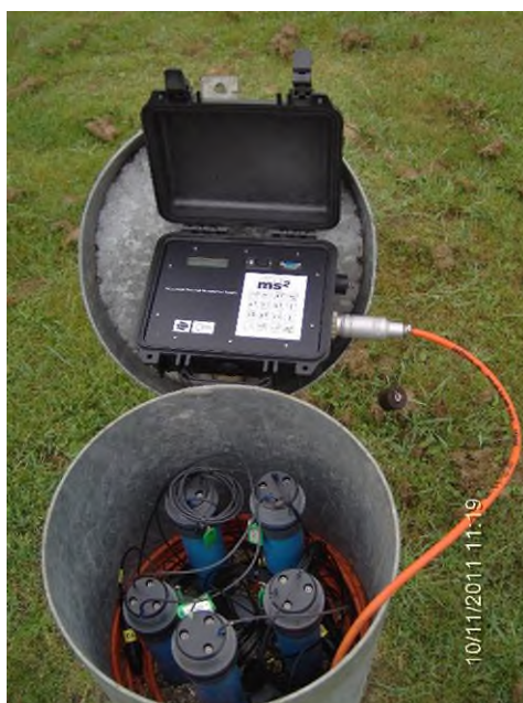
Figuur 33-18 Het uitlezen van een zoutwachter (foto WML).
