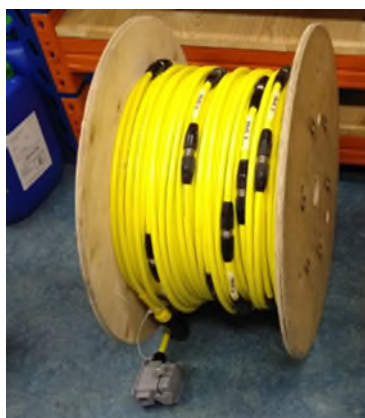
Figuur 33-12 Nieuwe zoutwachterkabel op haspel (foto Waternet).
